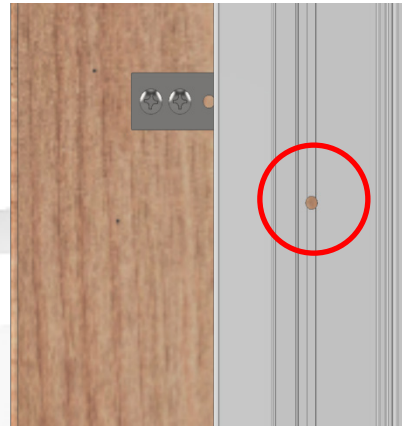
Figura 14: Orificios piloto de fijación de la jamba al descubierto
