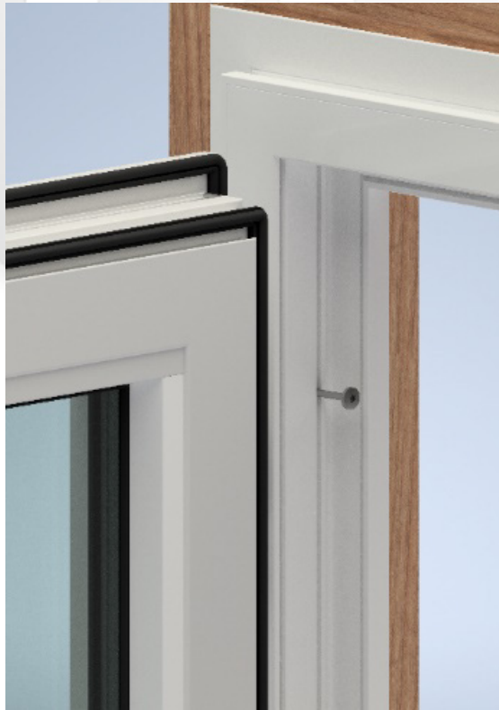
Figura 15: Sujetador de jamba parcialmente fijado
