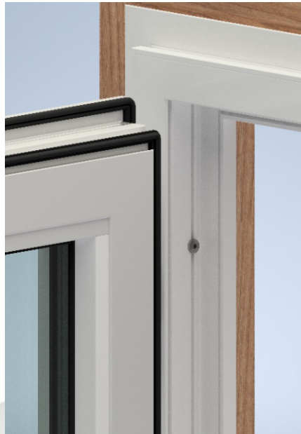
Figura 17: Sujetador de jamba totalmente calzado y fijado
