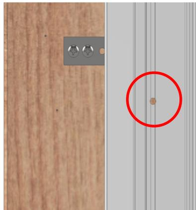
Рисунок 14. Доступ к базовым отверстиям для крепления бокового косяка
