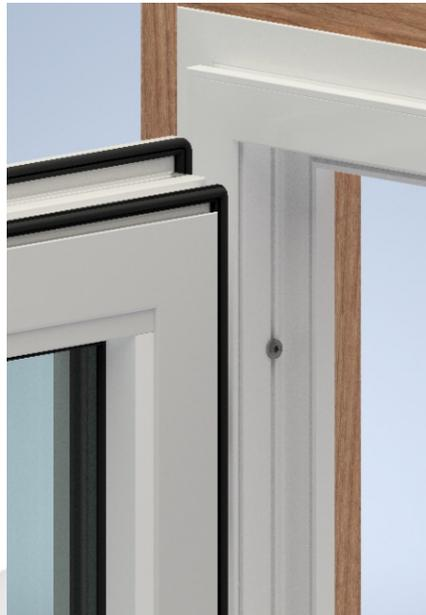
Рисунок 17. Полностью укрепленное подкладками и закрепленное предварительное крепление бокового косяка
