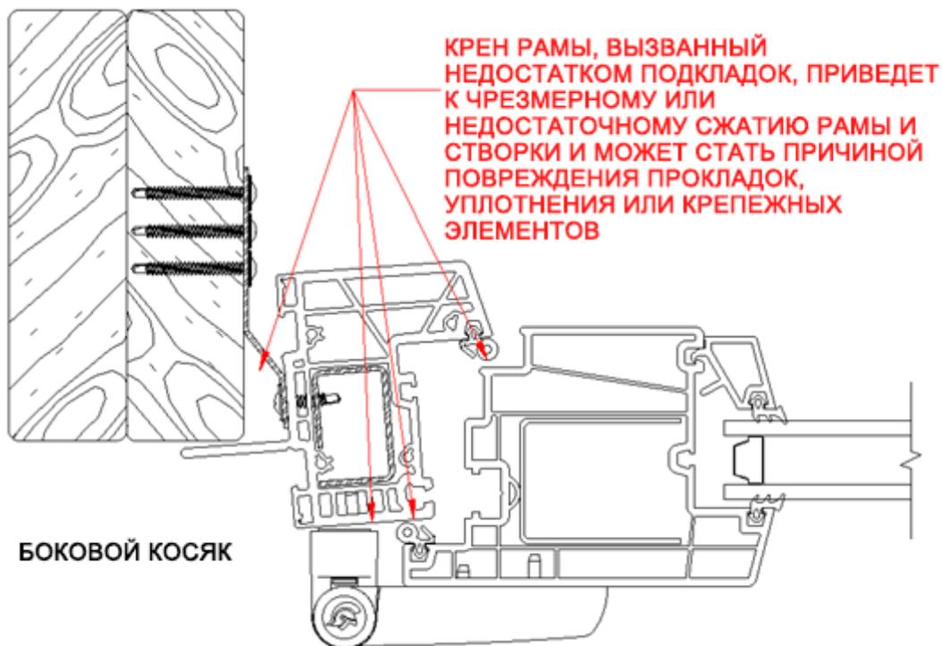
Рисунок 12. Дверной косяк: дверь со стальной планкой и креном рамы
