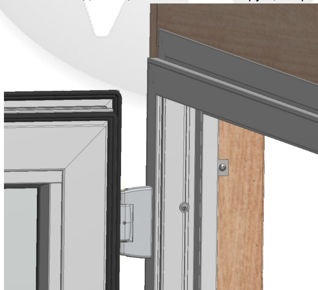
Рис. 13: Полностью укрепленное подкладками и закрепленное предварительное крепление бокового косяка
