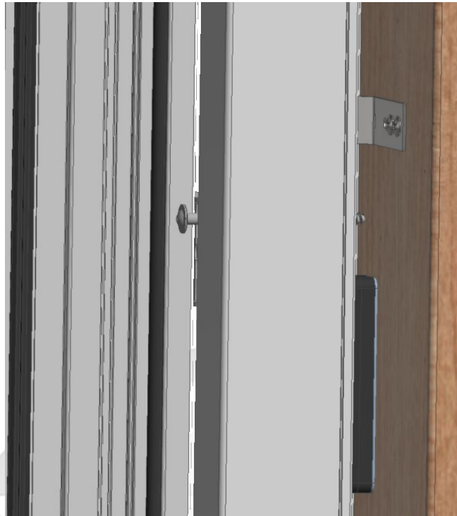
Рис. 12: Предварительное укрепление подкладками бокового косяка
