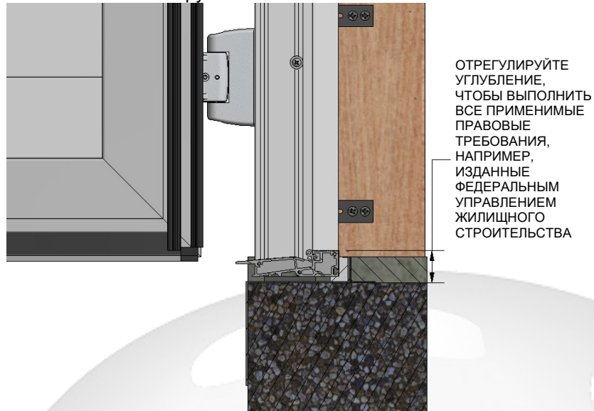
Рис. 4: Зазор от бетонной плиты на грунтовом основании до чистового пола
